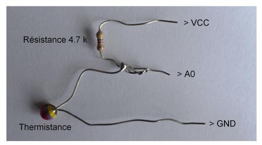
**Q.11)** Alimenter la carte et vérifier au multimètre la présence d'une tension voisine de 2,5V sur A0 lorsque le module Arduino uno est alimenté à la température ambiante.
