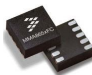
MMA8652 : accéléromètre de la carte micro:bit
